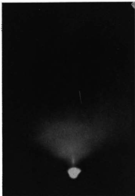
FIG. 14. — Diagramme fourni par la fonte polie; les halos indiquant une structure amorphe sont bien visibles, et au-dessus de l'intense faisceau non dévié, on voit une ligne verticale qui indique la présence de cristaux de graphite orientés avec le plan de glissement parallèle à la surface polie.
