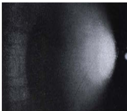
Fig. 7. — Diagramme donné par un cristal unique de carbure de silicium après oxydation superficielle; la couche de silice amorphe donne des halos mais elle est tellement mince que quelques électrons peuvent atteindre la surface même du cristal et donner alors des traces nettement visibles de diffraction par le cristal unique de carbure de silicium.
