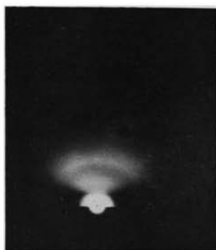
FIG. 3. — Diagramme de halos obtenu quand le faisceau rase une surface liquide ou solide mais amorphe, c'est-à-dire non cristalline.
