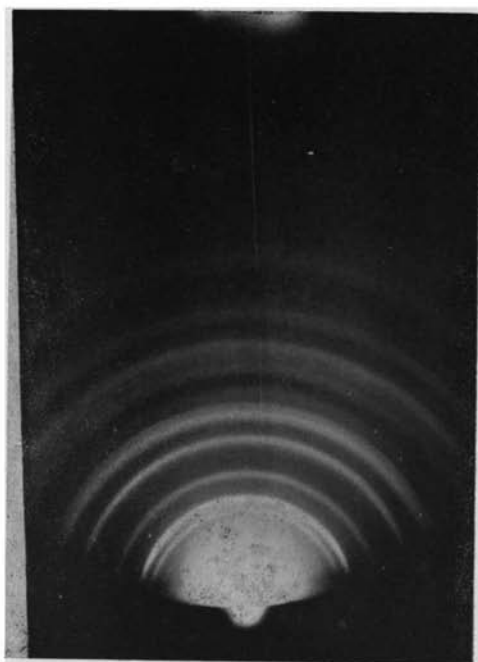
FIG. 1. — Diagramme fourni par la diffraction d'un faisceau d'électrons rasant une surface polycristalline.
