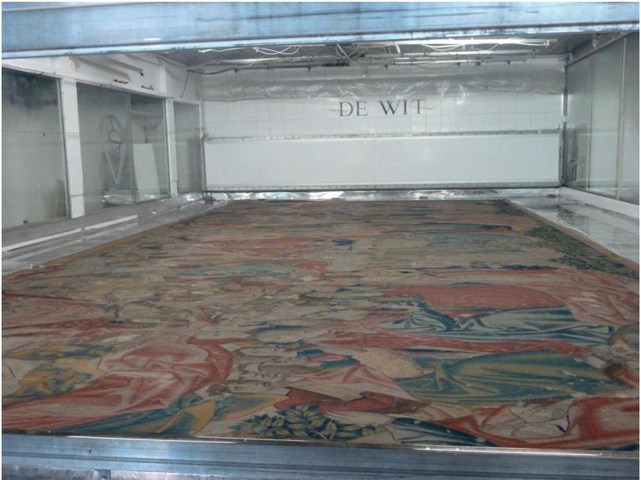
Fig. 2. Production d'aérosol au-dessus de la tapisserie étendue sur une table aspirante.
